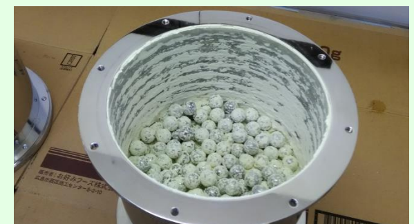
図-2 硫黄のみでの処理後(硫黄膜の形成)
