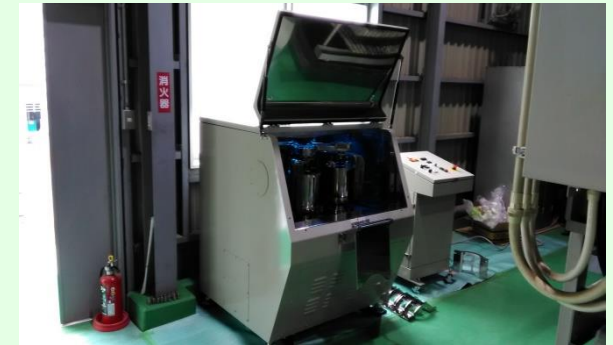
図-1 遊星ボールミル(実証装置)
