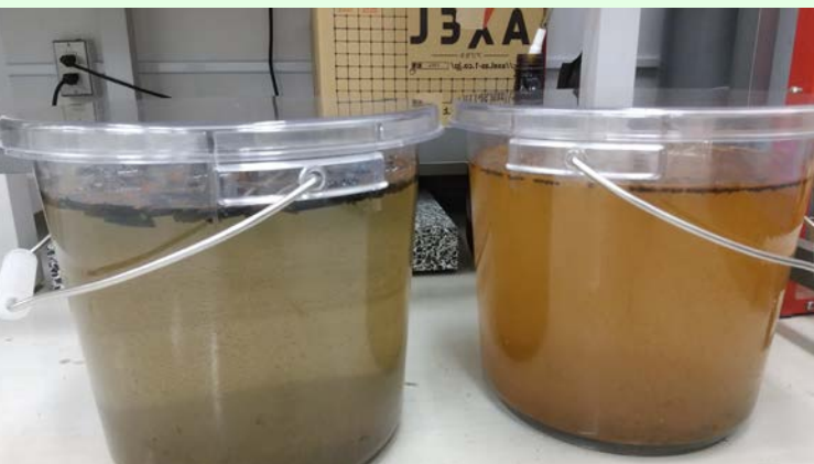
図4 鉄溶出室内実験(海水10Lに鉄粉100gを入れ, 左には竹炭を100g添加, 右は添加せず。)
