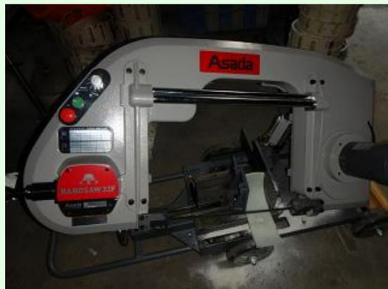
FRP容器の切断に使用する切断機
